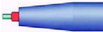
Figuur 4. Bij gebruik van een hoge lasstroom, zoals in het sproeihooggebied, is het aan te bevelen de contactbuis iets binnen het gasmondstuk te plaatsen.
